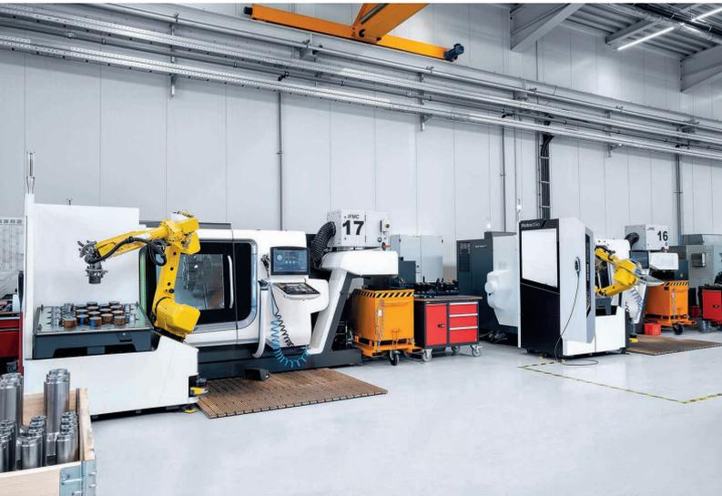
2 Drei Robo2Go an CTX-Drehzentren übernehmen bei ITH das Handling von Zylindern, Kolben, Stützhülsen und Wechselbuchsen in mittleren Losgrößen © DMG Mori
